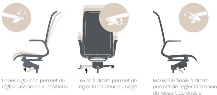
**réglage en hauteur** par vérin à gaz. Permet une excursion de 9 cm.
