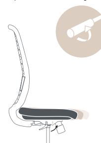
Levier avant droit permet de régler la profondeur de l'assise
