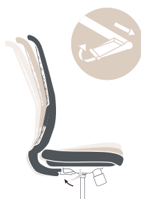
Le même levier permet de bloquer le dossier en 3 positions
