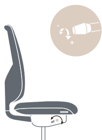
Volantino all'estremità della leva a destra per regolare la tensione della molla dello schienale
