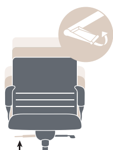
Leva a destra per regolare l'altezza della seduta
