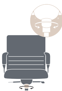
Pomolo centrale per regolare la tensione della molla dello schienale
