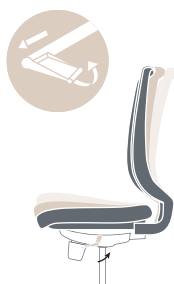
Leva a sinistra per bloccare l'inclinazione della seduta in 4 posizioni
