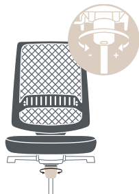
Pomolo centrale per regolare l'intensità della molla dello schienale
