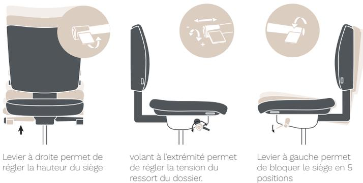
Levier à droite permet de régler la hauteur du siège
