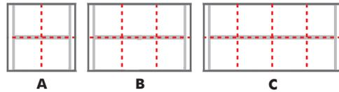
Structure back-to-back - Préparée pour un panneau de séparation revêtu (ép. 3 cm).
